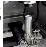
形彫放電加工機は主に自動車、IT製品、電気製品などのプラスチック金型やダイカスト金型の加工に使われています。
