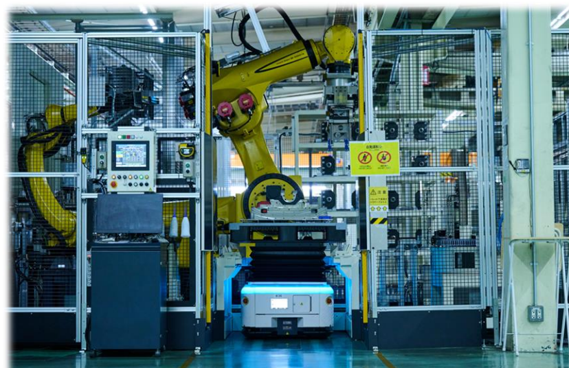
自社製AMRとロボットを活用した自動段取り
