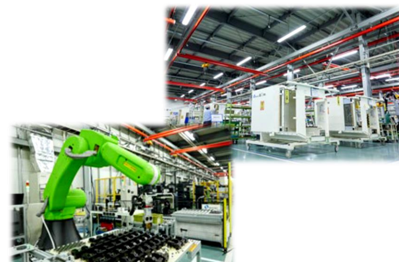
組立工程を細分化したモジュール生産方式
