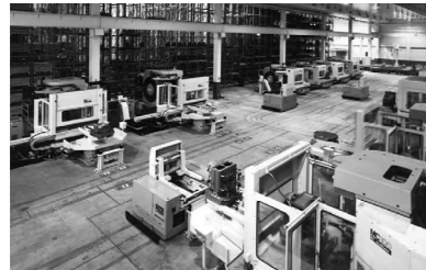
厚木事業所FMS工場(1983年) マシンングセンタ10台、無人搬送車3台、自動倉庫、 工具ステーション等で構成
