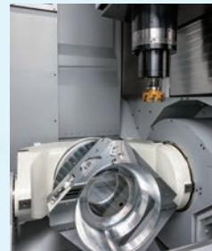
同時5軸加工と旋削機能により複雑な立体形状の加工工程を集約します
