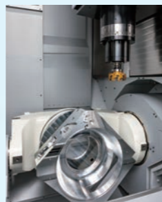
同時5軸加工と旋削機能により複雑な立体的加工工程を集約します
