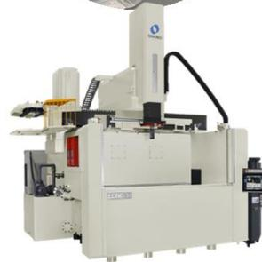
大型形彫放電加工機
